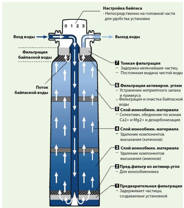
Конструкция фильтрующего картриджа BWT bestclear EXTRA с 7-ступенчатой фильтрацией
